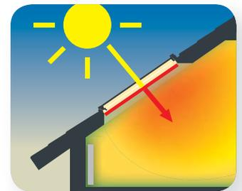
Les rayons solaires passent facilement le vitrage et son la raison d'un échauffement excessif de la pièce.
