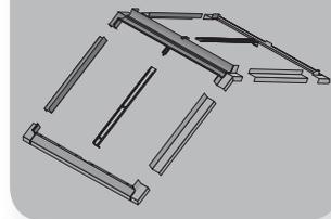
Lanterneau complet avec ossature en bois, abouts isolés, fenêtres de toit et raccords
