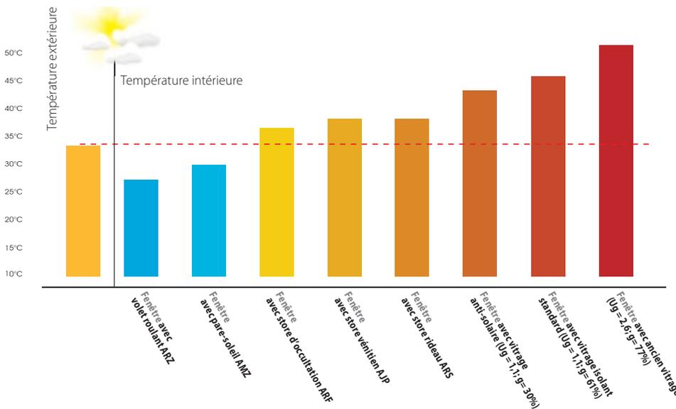
Températures maximales mesurées en fonction du type de protection solaire.
