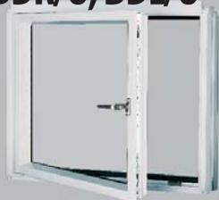
Ce modèle de fenêtre de façade fonctionne comme une fenêtre oscillo-battante traditionnelle. Le vantail s'ouvre de façon battante (à la française) ou de façon tombante. La poignée à mi-hauteur de l'ouvrant est pourvue d'une serrure à clef. Au choix, la fenêtre peut s'ouvrir par la droite (BDR) ou par la gauche (BDL, comme sur l'image).
