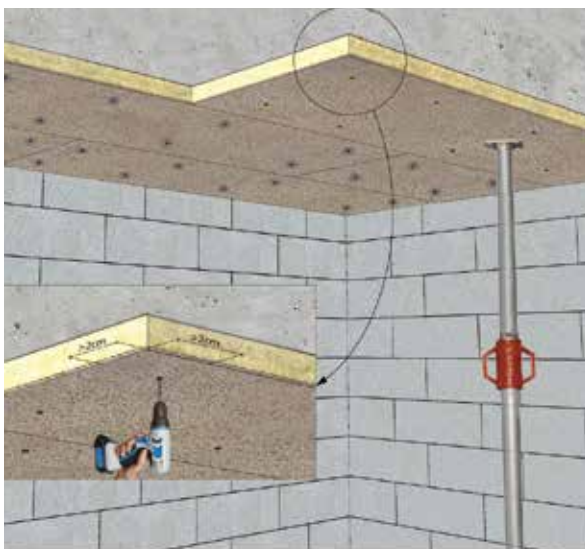
Fig. 13 : Fixation mécanique directe
