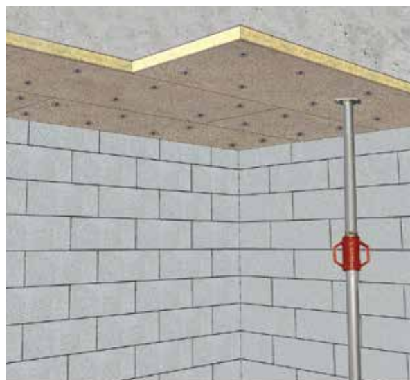
Fig. 14 : Mise en place et fixation des panneaux
