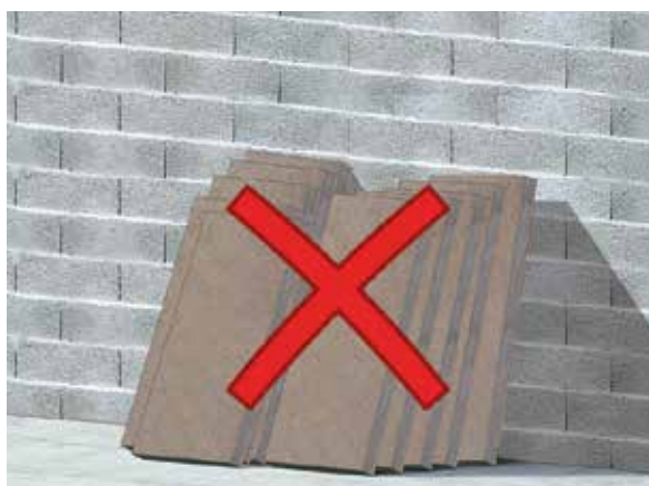
Fig. 17 : Stokage des panneaux à plat
