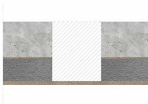
Fig. 8 : Réservation : continuité de la sous-face
