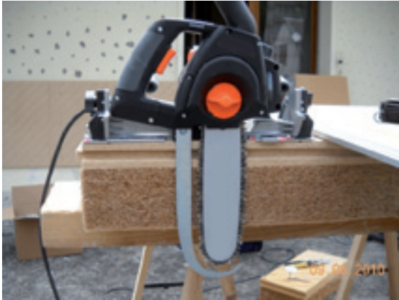
La mini-tronçonneuse est une machine confortable, à recommander pour la découpe.
