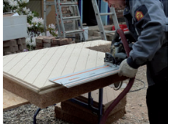
La machine s'utilise également pour réaliser des découpes précises au gabarit.
