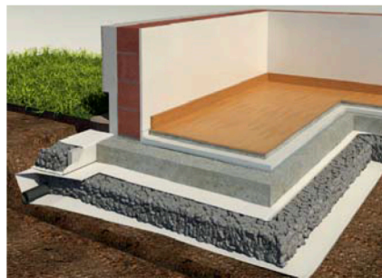
Isolation du périmètre sous la dalle de sol
