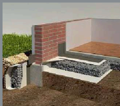
Isolation du sol, rénovation de bâtiments vétustes
