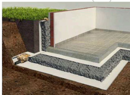
Isolation du périmètre à côté la dalle de sol et du mur de la cave
