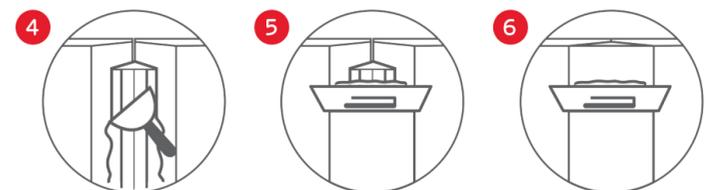
4 Appuyez délicatement avec la spatule sur la bande de renforcement pour la faire pénétrer dans l'enduit de jointolement.
