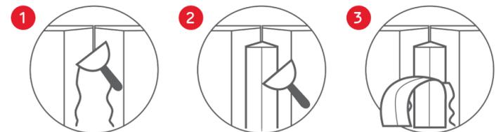
1 Comblez partiellement le joint au moyen du B-FILLER Siniat de votre choix, en fonction de la durée de traitement souhaitée. En cas de réalisation d'un projet de plus grande envergure, il est recommandé d'utiliser un B-FILLER dont la durée de traitement est plus longue.
