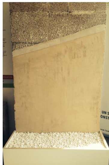
Finition enduite à la chaux
