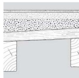
avec niveau intégré. Parallèlement à cette digue, à une distance égale à la longueur d'une règle d'égalisation, réaliser la même opération. Une fois les 2 digues réglées, l'épandage des granules peut commencer.
