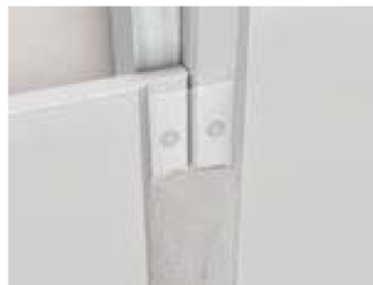
Jointoiement des plaques à bords amincis
