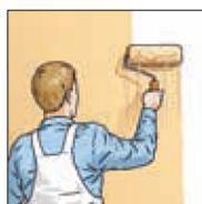
**7.** Après le séchage, recouvrir avec une peinture acrylique de qualité supérieure en conformité avec EN 13300.
